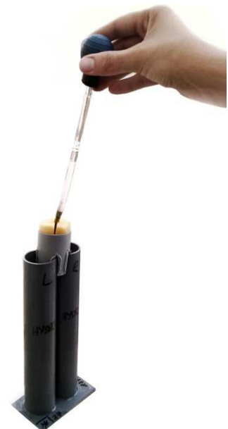
Abbildung 8 Pipettierung des Exsudats mit Hilfe einer Glaspipette in Eppendorfgefäße
